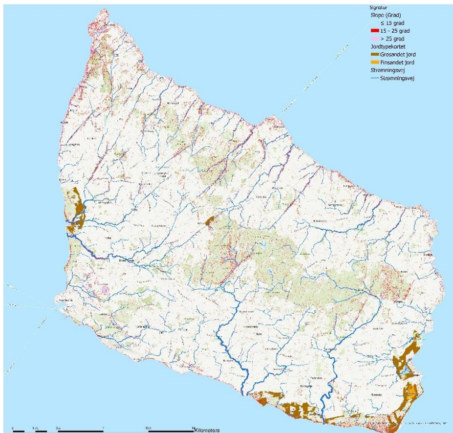
Figur 4-13 Kortlægning af strømningsveje, terrænhældninger samt jordtyper, som vurderes kritiske i forhold til erosion.
