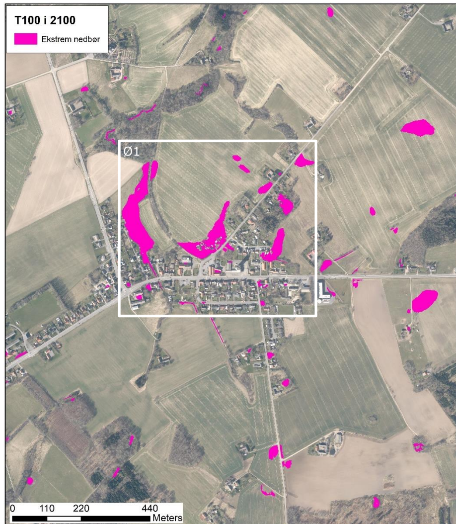
Figur 8-14 Kort over potentielle oversvømmelser fra ekstrem nedbør for en 100-års-hændelse i 2100 for Østerlars.
